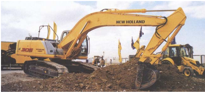
Slika 7. Bager E215LC-ME nova verzija iz serije New Holland bagera E215LC s dubinom kopanja do 12,88 m
