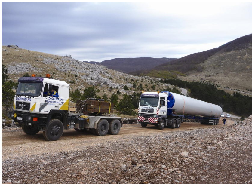
Proširena cesta omogućila je transport stupova
