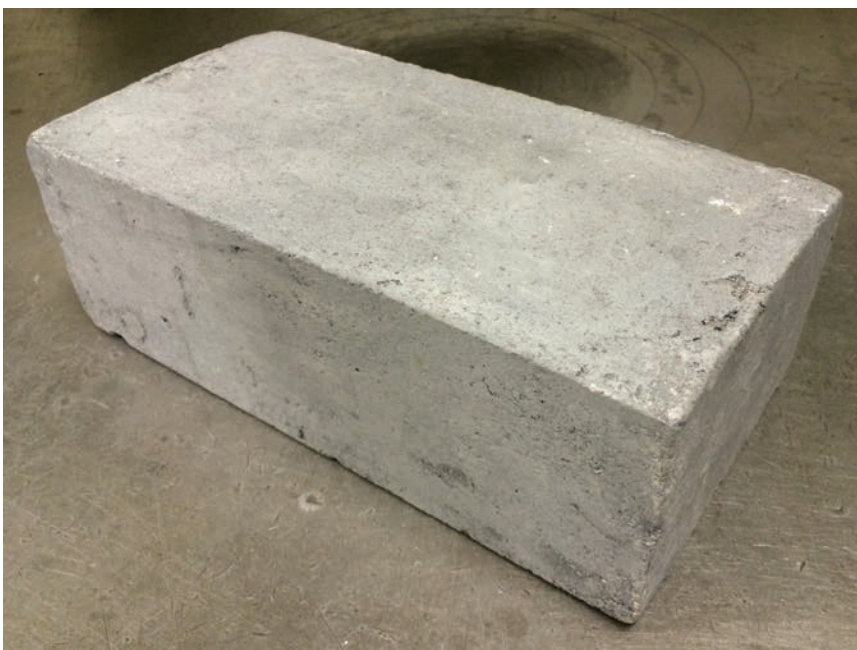
Eco-BLAC opeke suše se na sobnoj temperaturi
