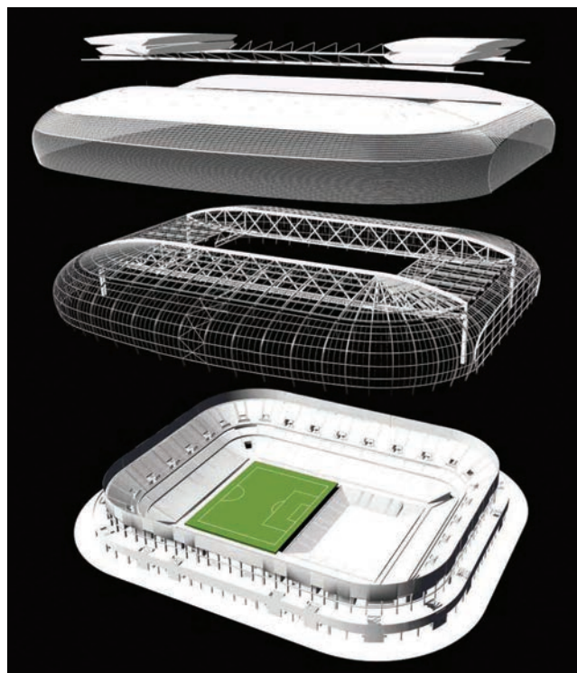
Dijelovi stadiona Pierre Mauroy : igralište s tribinama ovija čelična konstrukcija prekrivena prozirnom ljuskom, a na koju se oslanja pokretna krovna konstrukcija
