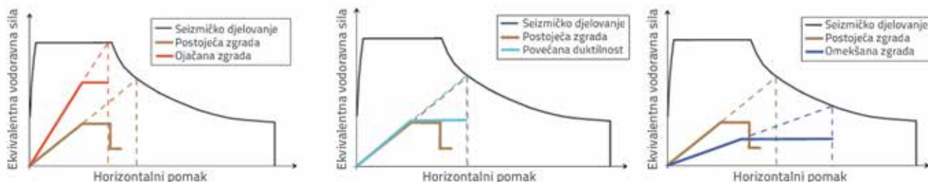
Slika 33. Tri različite strategije poboljšanja odziva konstrukcije na potresna djelovanja: ojačanje povećanjem krutosti i nosivosti (lijevo), povećanje duktilnosti odnosno deformacijske sposobnosti (sredina) i slabljenje konstrukcije (softening) primjerice ugradbom seizmičkih izolatora
