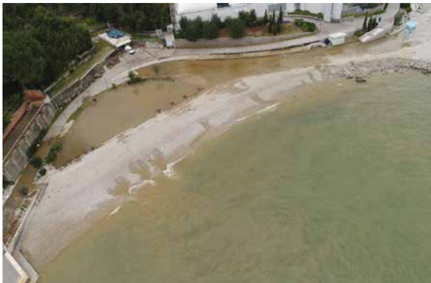
Erozija žala na plaži Ploče uzrokovana oborinskim dotokom 13. veljače 2020. (autor: Igor Ružič)
