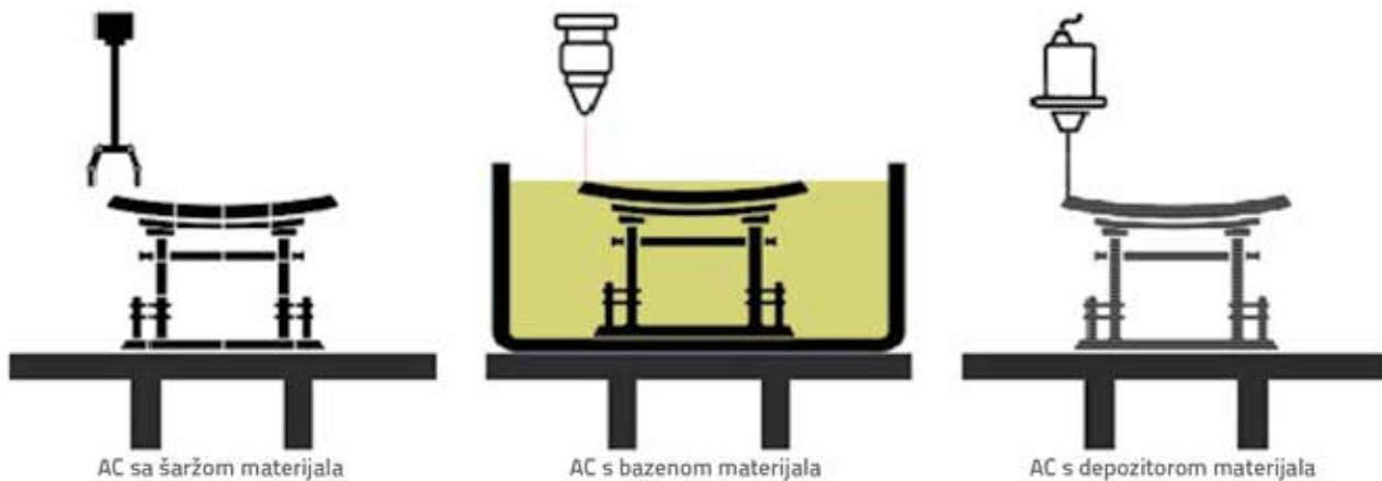
Slika 6. Aditivna gradnja (AC): AC s doziranjem materijala (lijevo); AC s komorom za materijal (sredina); AC s polagačem materijala (desno)
