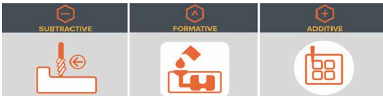
Slika 1. Shematska usporedba (lijevo) suptraktivnih, (sredina) lijevanih i (desno) aditivnih metoda proizvodnje [13]
