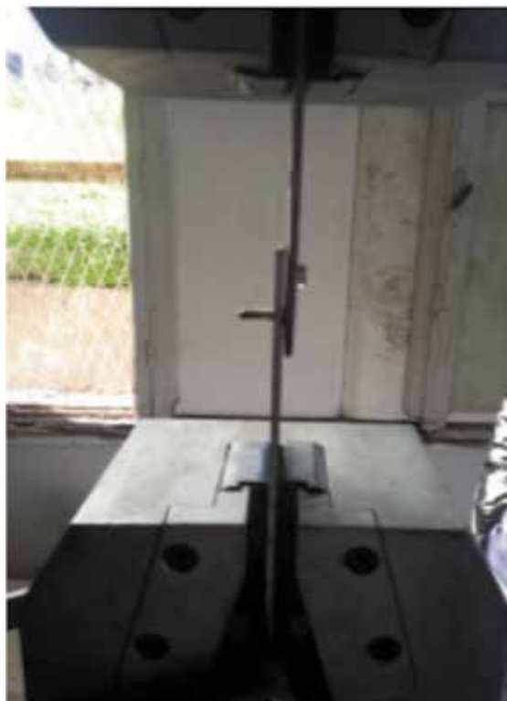
Slika 7. Vlačno ispitivanje uzorka
