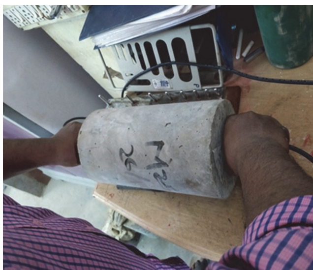
Slika 3. Ispitivanje betonskog uzorka UPV metodom
