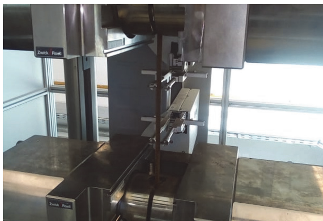
Slika 6. Uzorak neposredno prije ispitivanja
