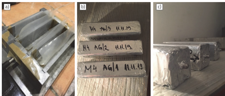
Slika 1. Ispitivanje autogenih deformacija: a) pripremljeni kalupi; b) uzorci obloženi aluminijskom folijom; c) mjerni reperi
