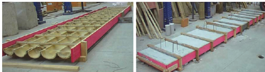
Slika 3. Trajne oplate od bambusa za betonske ploče [13]
