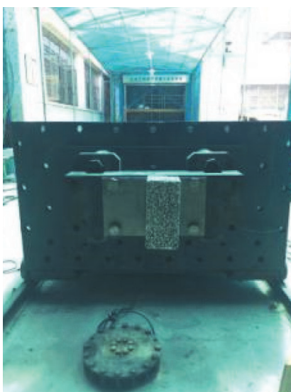
Slika 6. Zaštitni materijal CAF na testnom vagonu (vozilu)
