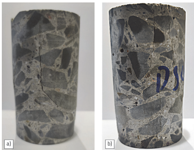
Slika 11. Način sloma modificiranog materijala pri različitom broju ciklusima smrzavanja i odmrzavanja: a) 0 ciklusa smrzavanja i odmrzavanja; b) 30 ciklusa smrzavanja i odmrzavanja
