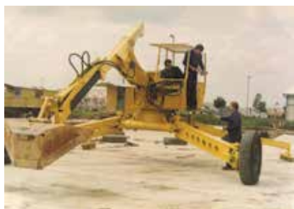
Slika 14. Stroj za čišćenje – izmuljenje melioracijskih kanala IV. i III. reda, 1980.
