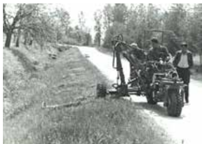
Slika 15. Samohodna kosilica za redovito održavanje melioracijskih kanala IV. reda
