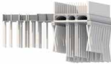
Ojačanje temeljnog tla – prostorni prikaz stupnjaka
