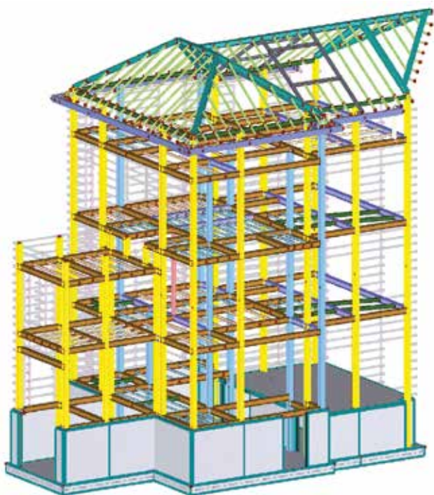
Prostorni FE model konstrukcije nožice
