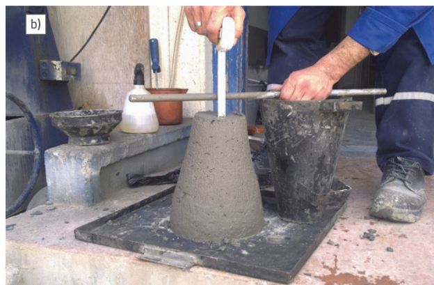
Slika 4. a) Vrijednosti tlačne čvrstoće skupa valjkastih uzoraka dobivenih iz mješavine T5; b) Ispitivanje mješavine T5 pomoću lijevka koje pokazuje slijeganje od 4 cm
