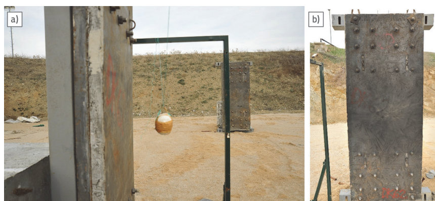
Slika 18. a) eksploziv C4 postavljen 25 cm od prednje strane ploča; b) lice ploče nakon eksplozije s vidljivim opečanim površinama, ali bez primjetnih konstrukcijskih oštećenja
