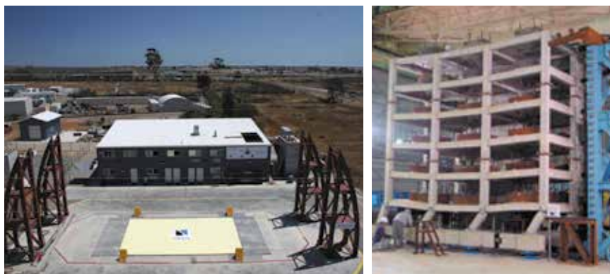
Slika 5. Potresna platforma u NEES-u na Kalifornijskom sveučilištu u San Diego u SAD-u (lijevo) i u NIED-u, u prefekturi Hygo u Japanu (desno)
