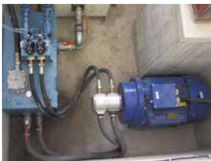
Slika 7. Elektrohidraulički sustav (lijevo), upravljački servo razvodnik (sredina) i upravljački pult (desno)
