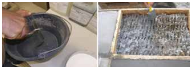
Slika 6. Priprema veznog sloja: doziranje i ručno miješanje morta s lateksom oznake LMC+ s utrljavanjem u površinu podložnog betona
