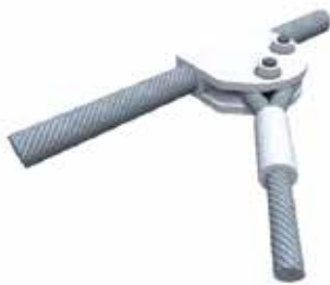
Slika 8. Spoj unutarnjega kabela na rubni (prema [19])
