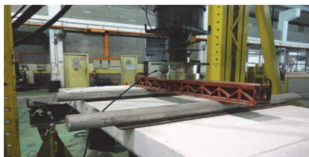
Slika 12. Prijenos dvaju linijskih opterećenja na ploču
