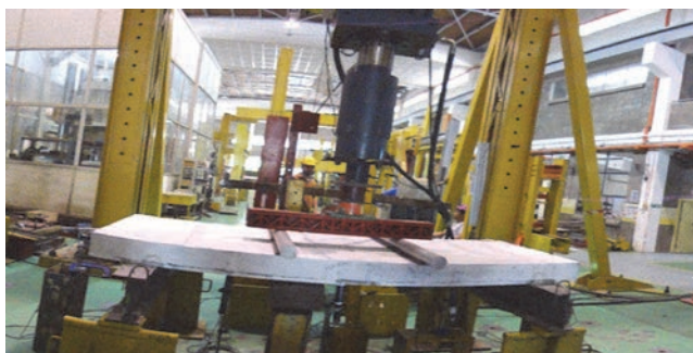
Slika 14. Tipični izgled uzorka nakon sloma
