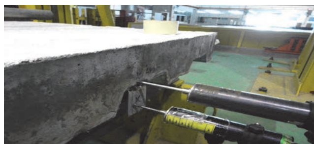
Slika 11. Prikaz mjerenja proklizavanja između valovitog čeličnog lima i betona pomoću LVDT
