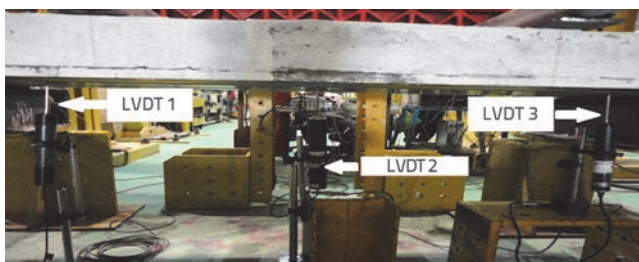
Slika 10. LVDT uređaji postavljeni na sredini i na četvrtinama raspona
