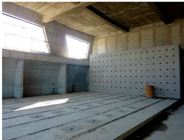
Reaktivni zid i ploča za seizmička laboratorijska ispitivanja
